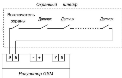
Рисунок 5. Схема охранного шлейфа.
